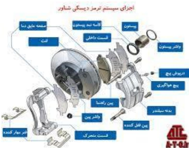
**ترمزهای دیسکی با پایه ثابت:** این نوع ترمز دیسکی، معمولاً 2 تا 4 پیستون دارد. در هنگام وارد آمدن فشار روغن ترمز، هر دو یا چهار پیستون، به طور متقابل به طرف هم حرکت کرده دیسک را در میان خود فشار می دهند. در این سیستم، پایه پیستون ها ثابت است و به عضو ثابت محور، بسته می شود.
