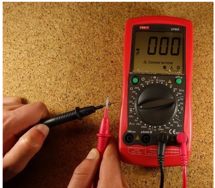
مولتی‌متر در مد بررسی اتصالات هنگام اتصال دو پراب آن به یکدیگر
