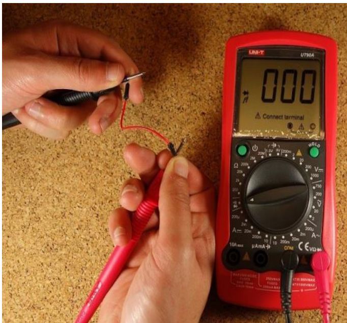
مولتی‌متر در مد بررسی اتصالات برای یک سیم
